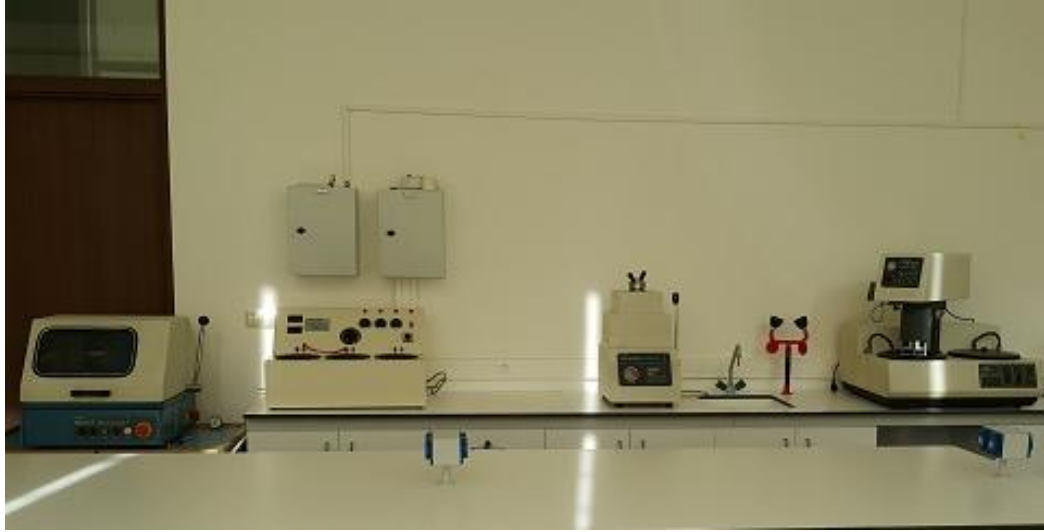
Şekil 6.5. Metalgrafik numune hazırlama cihazları
