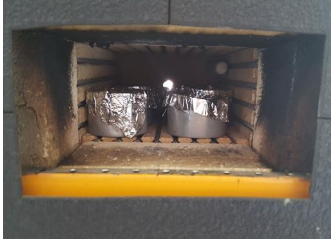
Fotoğraf 3.10. Kompost örneklerinin fırın kurusu haline getirilme işlemi
