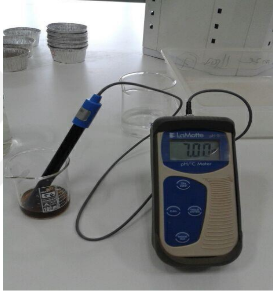
Fotoğraf 3.7. pH metre ile kompost pH değerinin tayini
