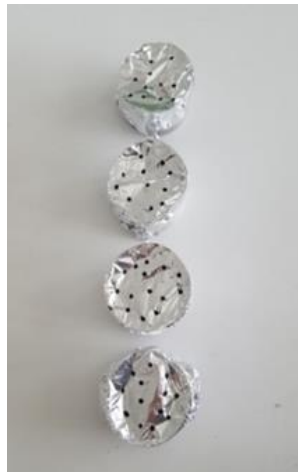
Fotoğraf 3.9. Fırın kurusu öncesi delinmiş alüminyum folyo ile kaplı örnekler
