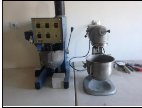
Fotoğraf 3.13. Manuel çimento mikseri
