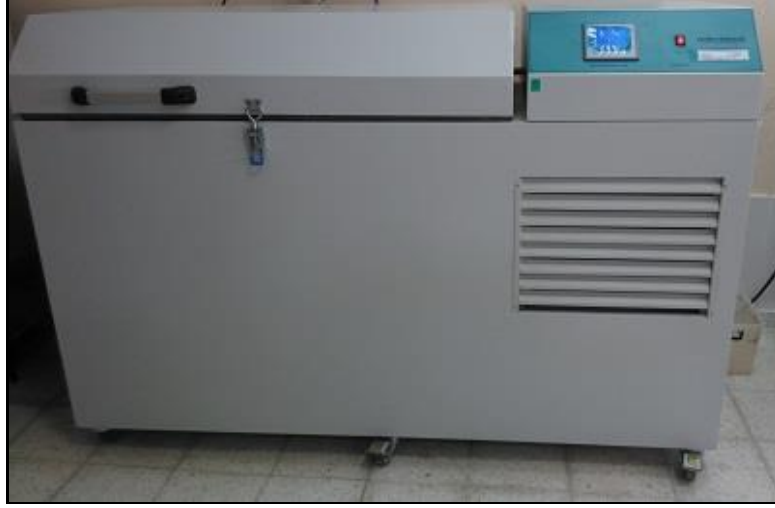
Fotoğraf 3.20. Donma-çözünme deney cihazı
