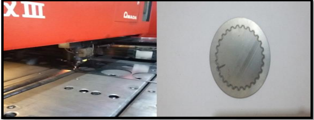
Şekil 3.3. HSLA Çeliğinde CO 2 Lazer ile Oyuk Yapılması
