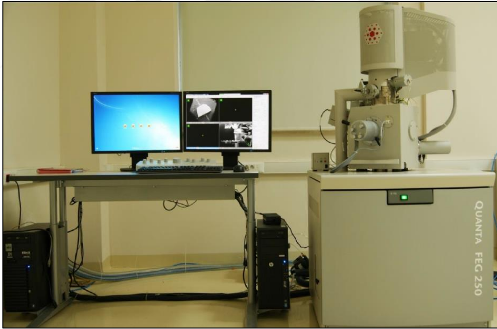
Fotoğraf 5.5. SEM ve EDS analizinde kullanılan FEI Quanta Feg 250 model taramalı elektron mikroskobu ve EDAX marka enerji dağılım spektroskopisi
