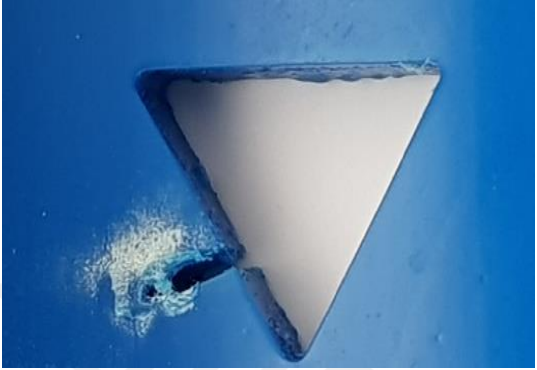
Şekil 3.27. Oksijenle kesilen üçgen örneğinin iç kısmı
