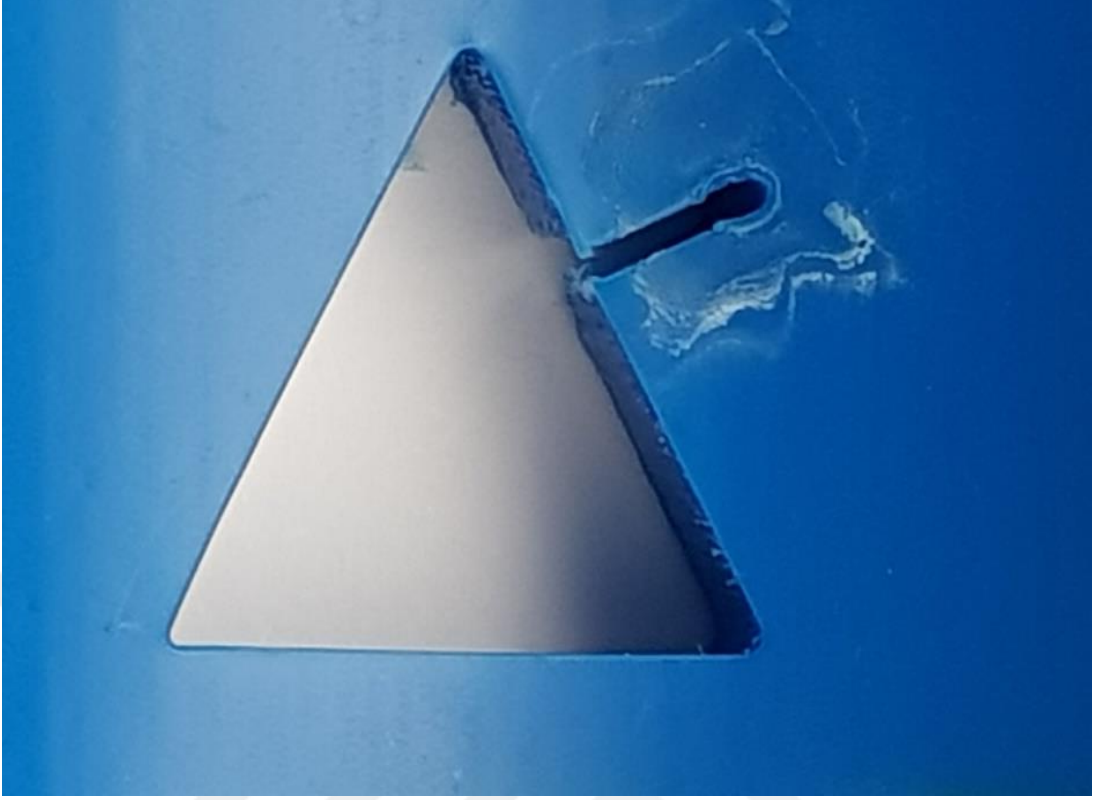
Şekil 3.13. Havayla kesilen üçgen örneğinin iç kısmı
