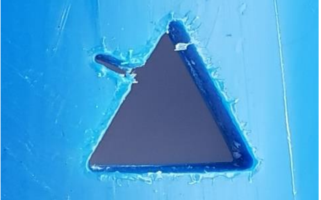
Şekil 3.14. Havayla kesilen üçgen örneğinin dış kısmı
