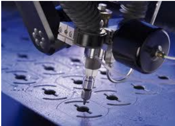
Şekil 2.3. Su jeti ile kesme işlemi
