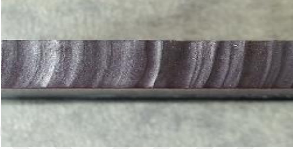
Şekil 2.21. Kesim hattı girdap çizgileri
