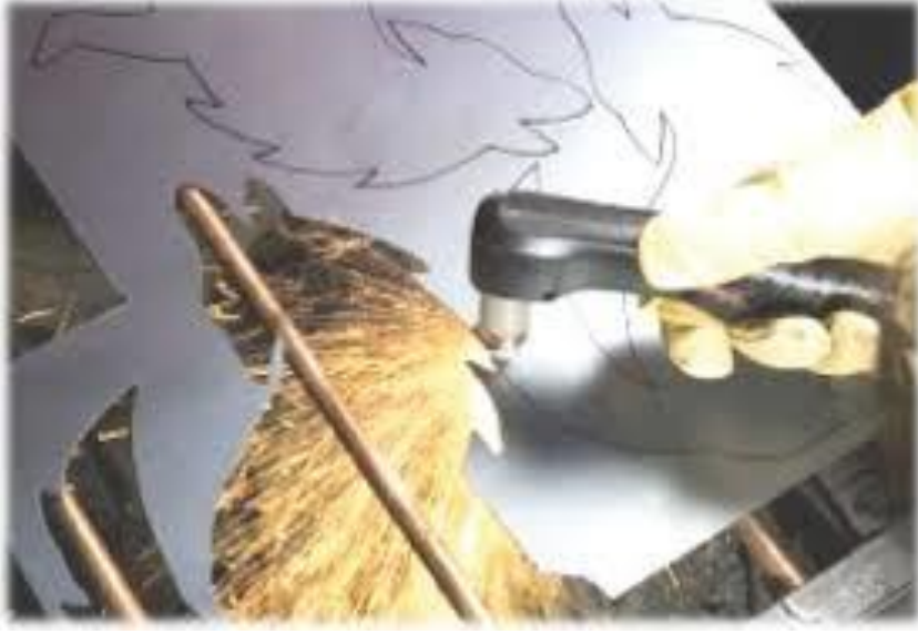
Şekil2.6. Plazma ile kesme
