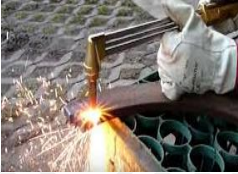
Şekil 2.5. Oksijen ile kesme işlemi
