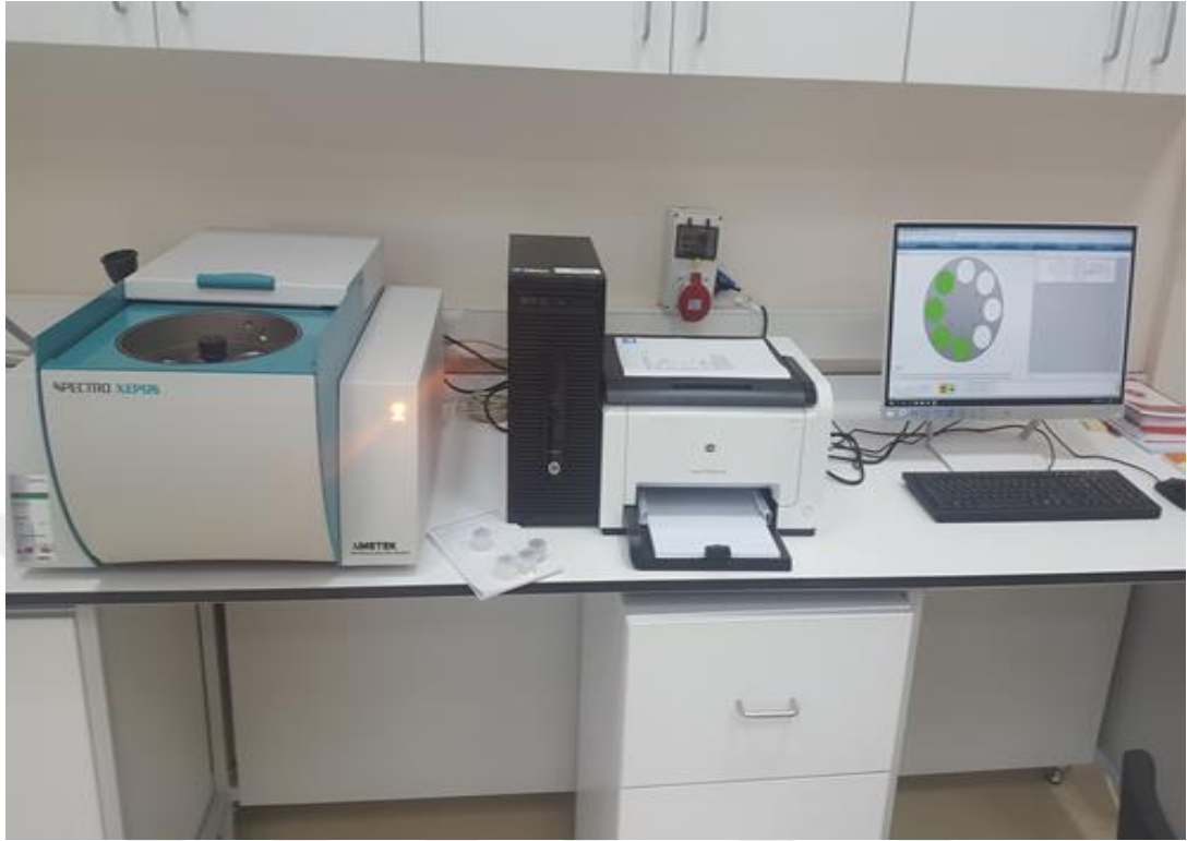
Fotoğraf 3.3. Analiz işlemleri için kullanılan EDXRF spektrometresi
