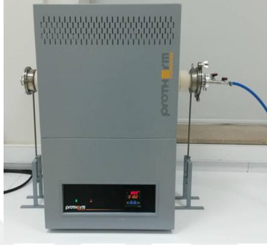
Şekil 6.3. Atmosfer kontrollü ısıl işlem fırını
