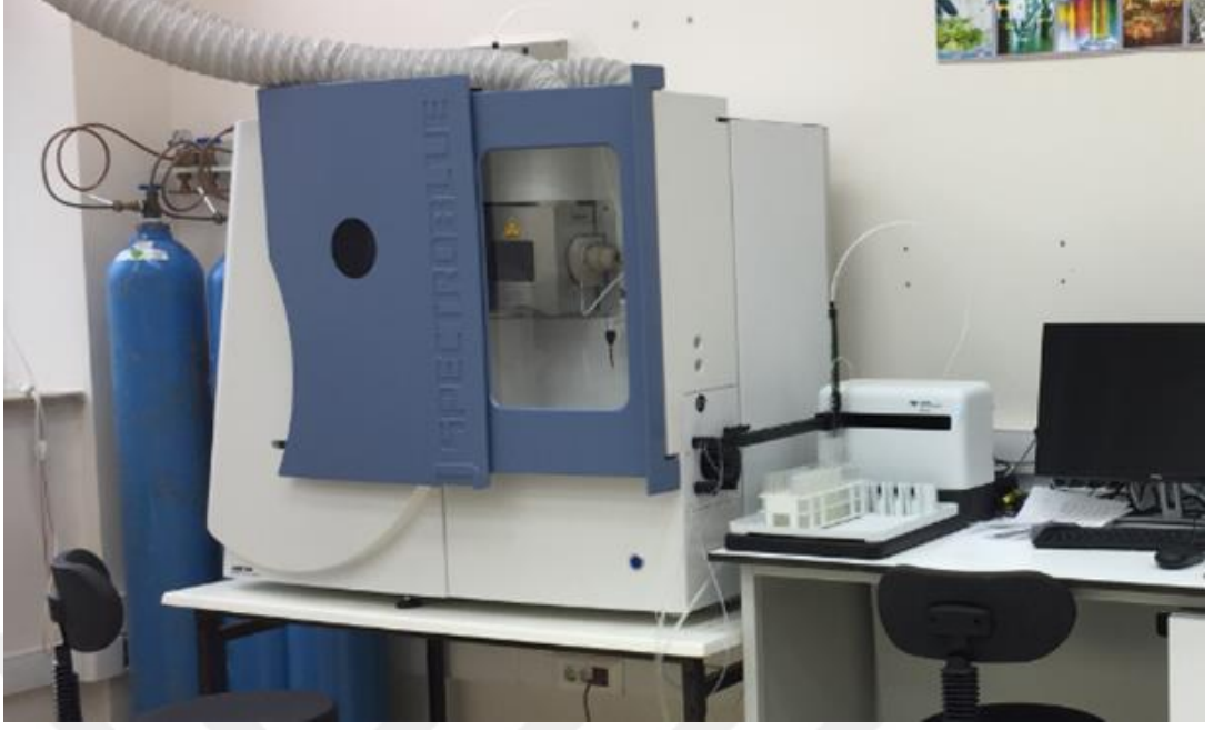
Fotoğraf 3.3. Ağır metal analizlerinin yapıldığı ICP-OES cihazı
