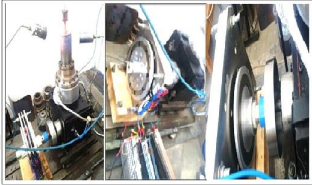
Fotoğraf. 3.2. (a) Jeneratörüne bağlı beta tipi Stirling motor için (b) sistemin volani bileşeni dönerken (c) motor kafasının laboratuvarda ısıtılması
