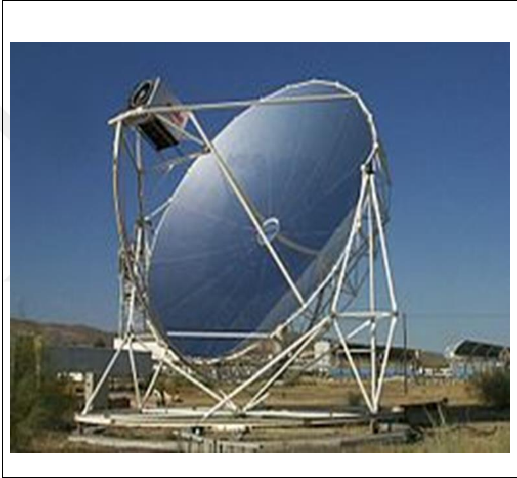
Şekil.1.1. Yoğunlaştırıcı güneş enerjisi sistem ile Stirling motorunun (SM) gösterimi
