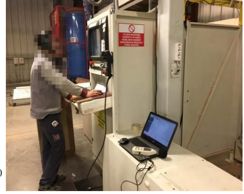
Şekil 6.16. Kanal Delik Delme (Morbidelli ) makinesi zaman ağırlıklı gürültü grafiği ve fotoğrafı
