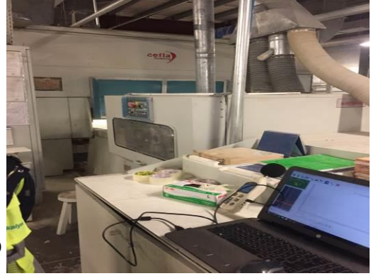
Şekil 6.10. Otomatik UV Sprey Hattı (Cefla) zaman ağırlıklı gürültü grafiği ve fotoğrafı
