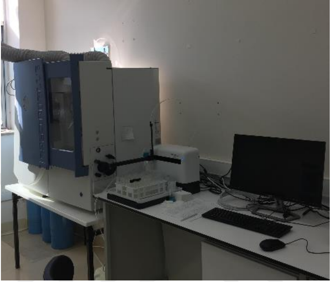
Fotoğraf 3.4. Analizlerin yapıldığı ICP-OES cihazı
