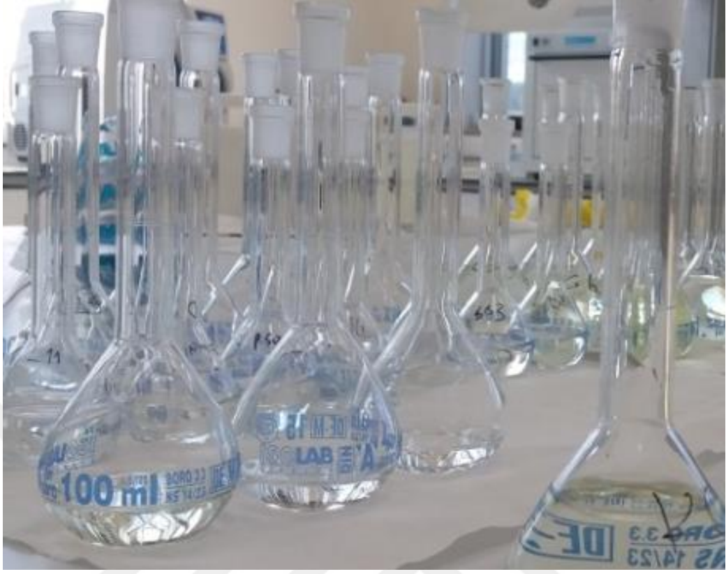
Fotoğraf 3.3. Mikrodalgadan çıkan örneklerin soğuması için bekletilmesi
