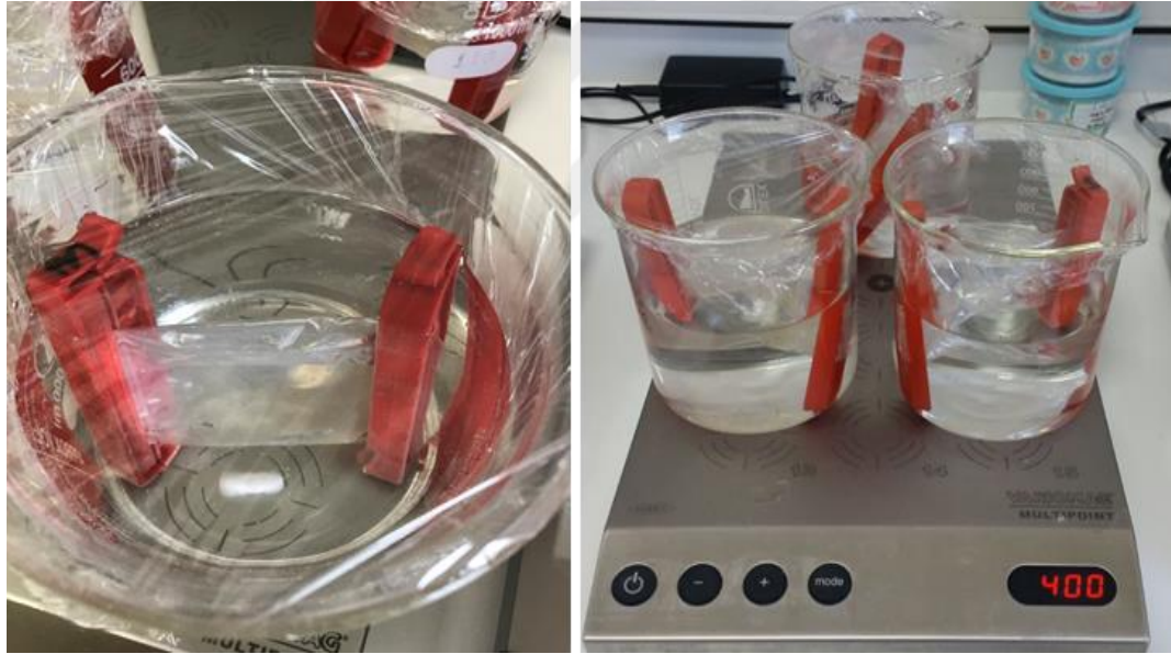
Şekil 5.3. Ajisawa çözeltisiyle hazırlanan fibroin çözeltisinin diyaliz membran kullanımı ile osmoz olayı kullanılarak saflaştırılması işlem adımları.
