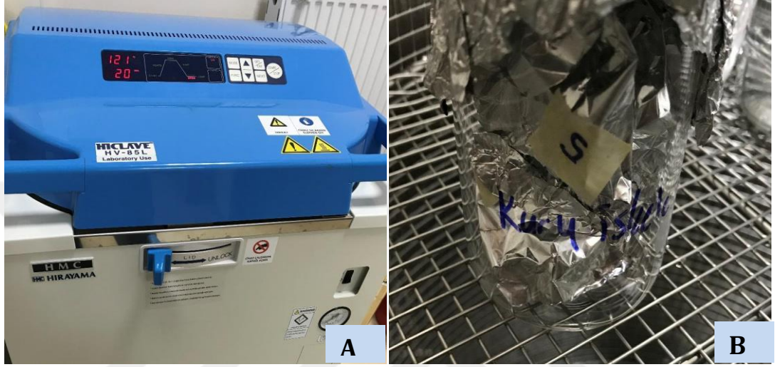
Şekil 5.7. A. Buharlı otoklav B. Liyofilizasyon sonrasında elde edilen fibroin iskelelerin kuru halde otoklav işlemi için hazırlanmış numuneler
