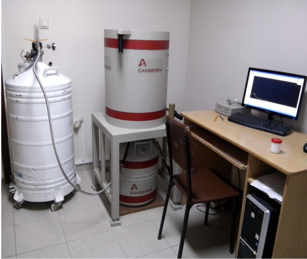
Fotoğraf 3.2. HPGe dedektörlü gama-ışını spektrometresi
