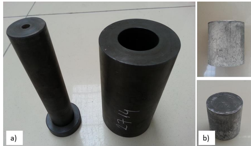
Fotoğraf 6.3. Soğuk presleme kalıp takımı (a), sıkıştırma sonrası üretilen biyet numune (b)
