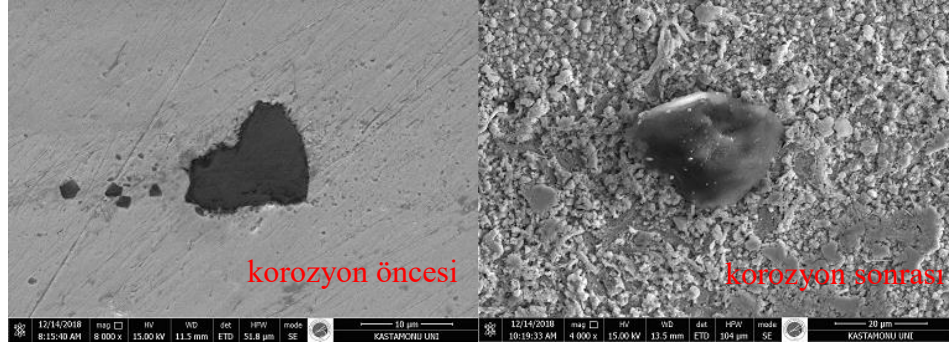
Şekil 8.20. Bor karbürün korozyon öncesi ve korozyon sonrası SEM görüntüsü
