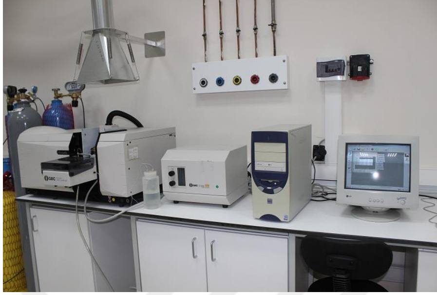
Fotoğraf 3.3. Ağır metal konsantrasyonları belirlemede kullanılan AAS cihazı
