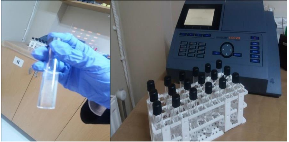
Resim 3.2. Test kitinin uygulanması ve lmünün yapıldığı spektrofotometre cihazı
