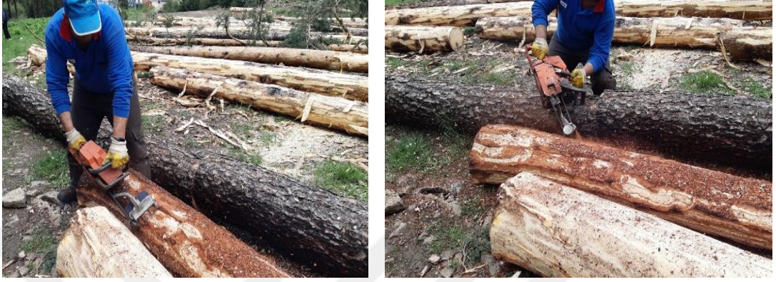
Fotoğraf 3.7. Motorlu testereye monteli kabuk soyma ekipmanı
