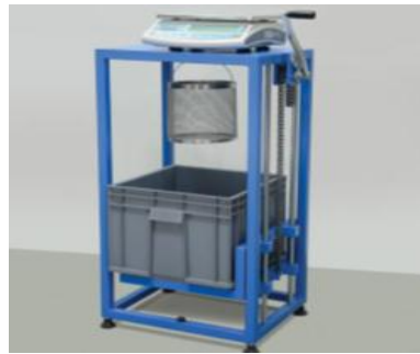
Şekil 3.15. Arşimet test ekipmanı
