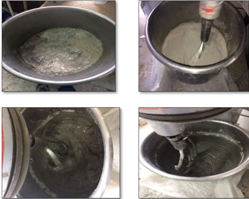
Şekil 3.10. Geopolimer karıştırma süreci
