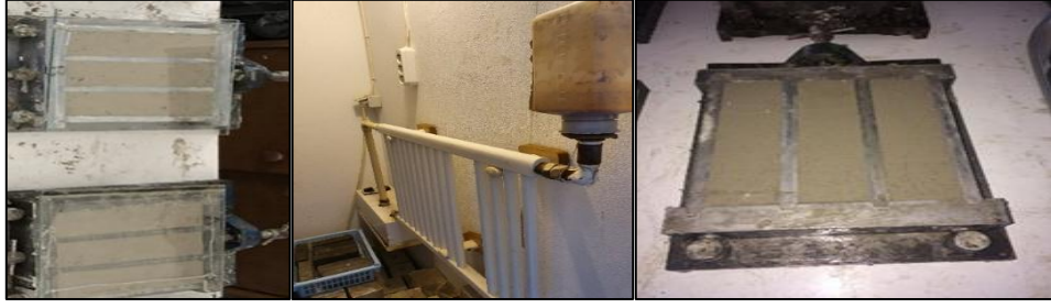
Şekil 3.10. Beton döküm ve buhar küri
