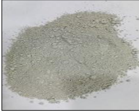
Şekil 3.1. Öğütülmüş granül yüksek fırın cürufu (YFC)
