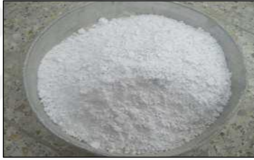
Şekil 3.5. Cam tozu parçacıkları (13 µm)
