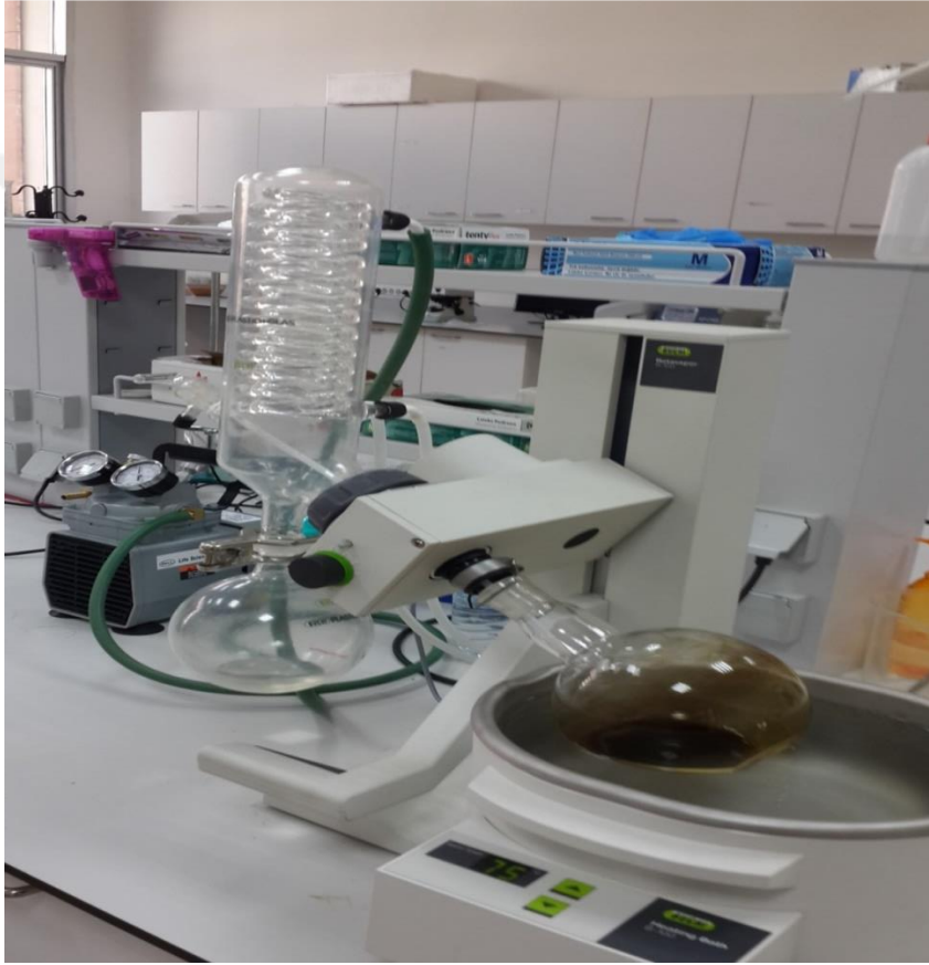
Fotoğraf 3.4. Toz haline getirilmiş bitkilerin sulu methanolik özütleri çıkarılma işleminde kullanılan evaporatör cihazı
