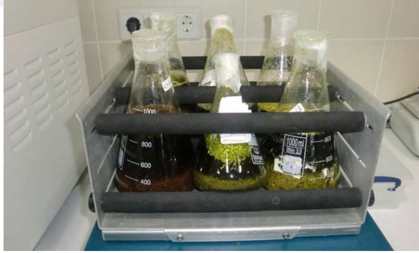
Fotoğraf 3.2. Çalkalayıcı üzerindeki bitki örneklerinin ekstraksiyonu.
