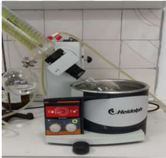
Fotoğraf 3.4. Rotary evaporatör kullanarak etanolün buharlaştırılması
