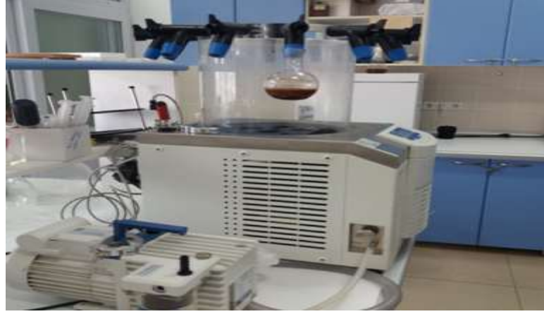
Fotoğraf 3.5. Örneklerdeki suyun liyofilizatörle buharlaştırılması
