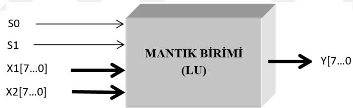
Şekil 3.25. Mantık biriminin yapısı
