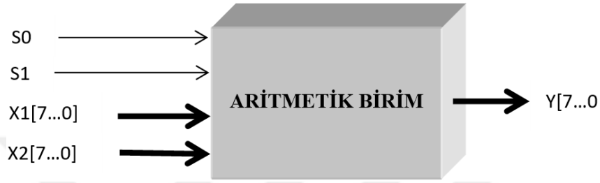
Şekil 3.23. Bir aritmetik birimin yapısı.
