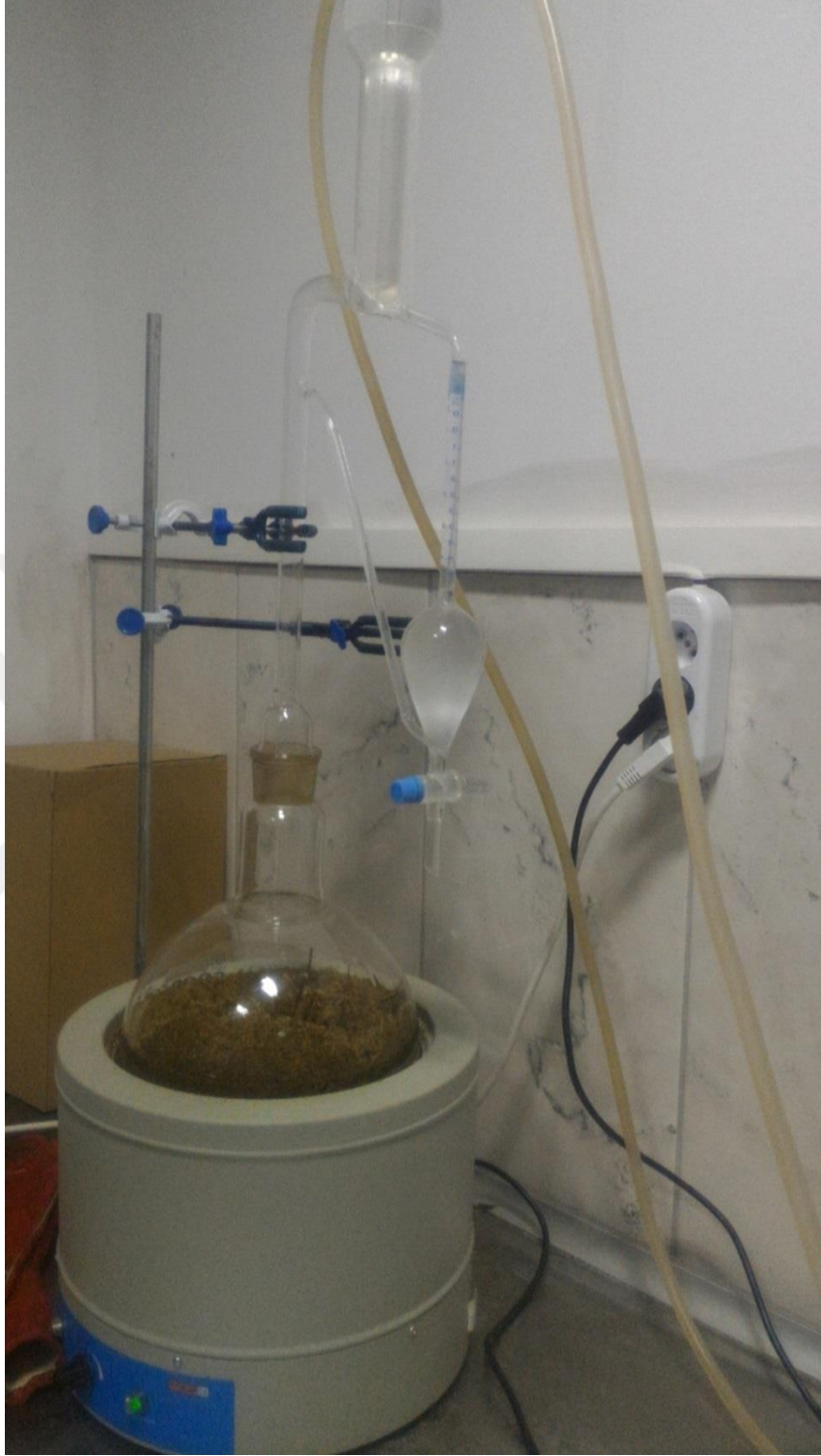
Fotoğraf 3.4. Clevenger uçucu yağ cihazı
