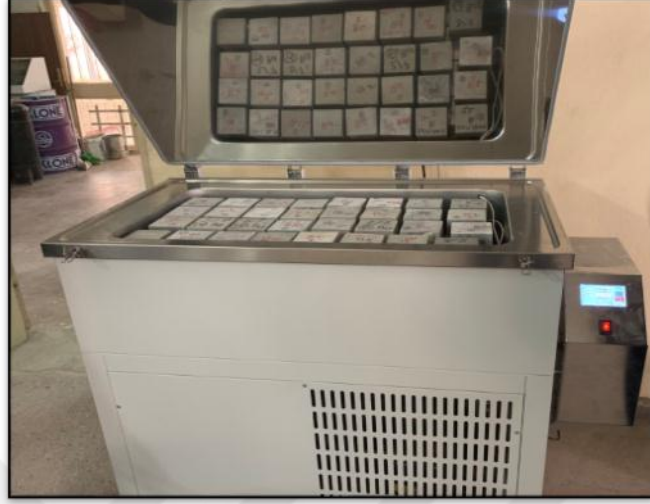
Şekil 3.11. Donma-çözülme test cihazı ve numuneler
