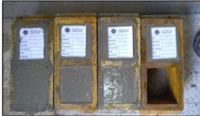
Şekil 3.8. Kalıplanan KYB numuneleri
