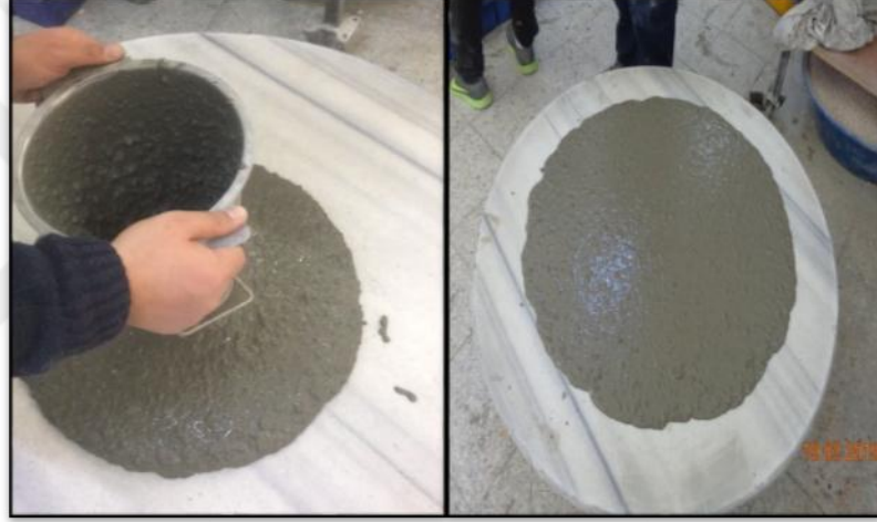
Şekil 3.7. KYB numunelere uygulanan çökme-yayılma testi
