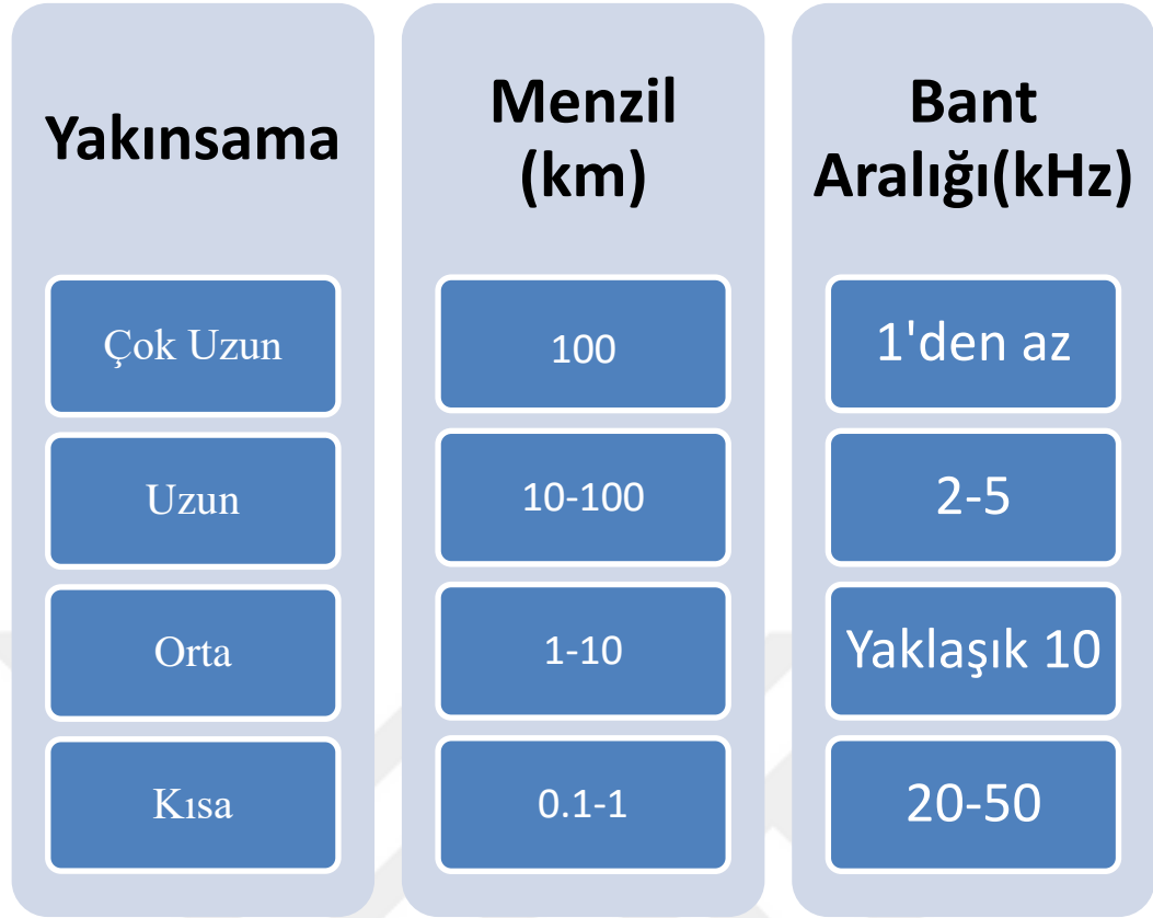
Şekil 2.13. Sualtı kablosuz sensör ağları (SKSA'lar) için bant genişliği ve iletim aralığı ilişkisi (Khan vd, 2018).
