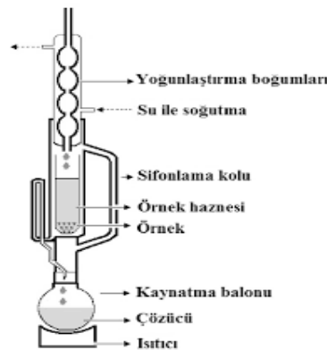
Şekil 2.18. Sokslet ekstraksiyon
