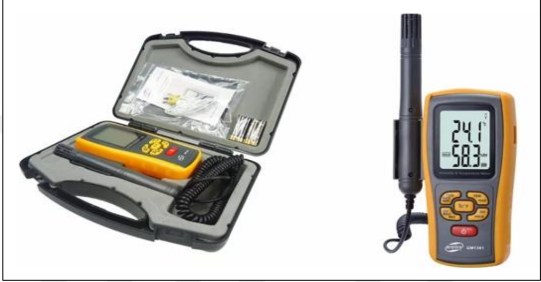
Şekil 3.4. Nem ve Sıcaklık Ölçer (GM1361)
