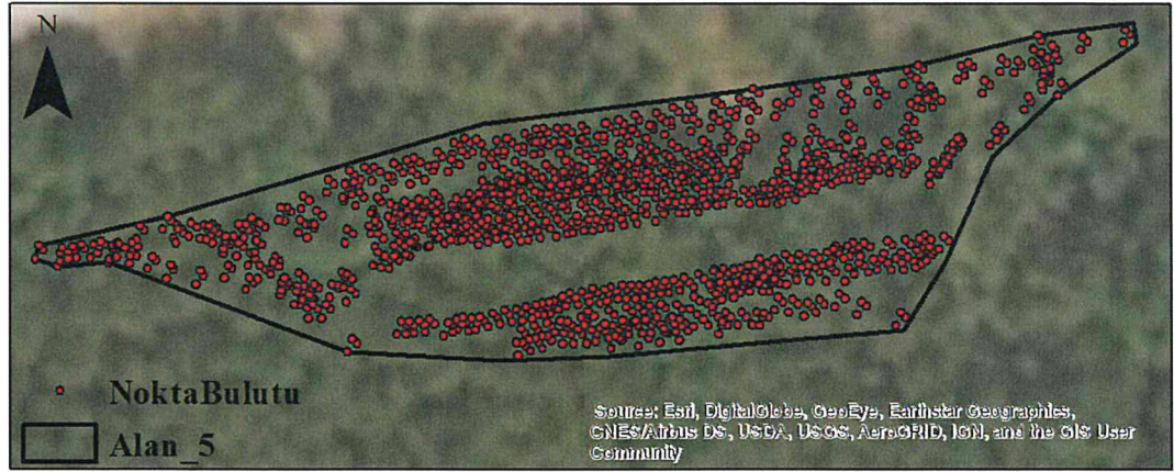
Şekil 29. 5 nolu Çalışma Alanına Ait Alan Sınırı ve Total Station Kullanılarak elde edilmiş Nokta Bulutu
