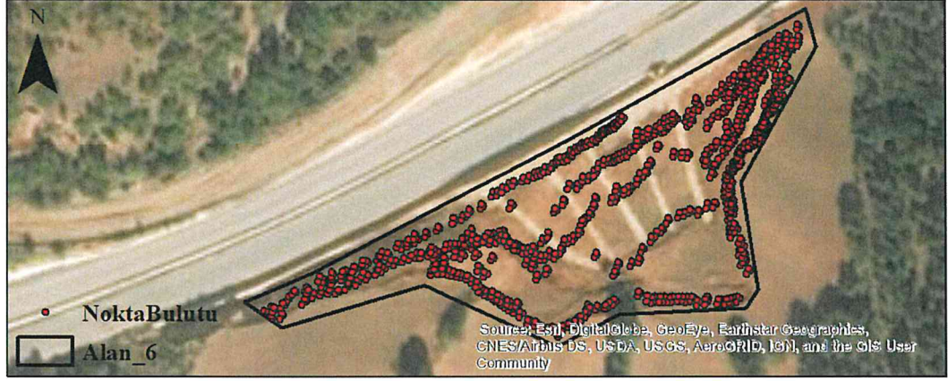
Şekil 3.34. 6 nolu Çalışma Alanına Ait Alan Sınırı ve Total Station Kullanılarak elde edilmiş Nokta Bulutu
