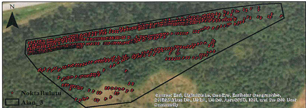
Şekil 3.20. 3 nolu Çalışma Alanına Ait Alan Sınırı ve Total Station Kullanılarak elde edilmiş Nokta Bulutu
