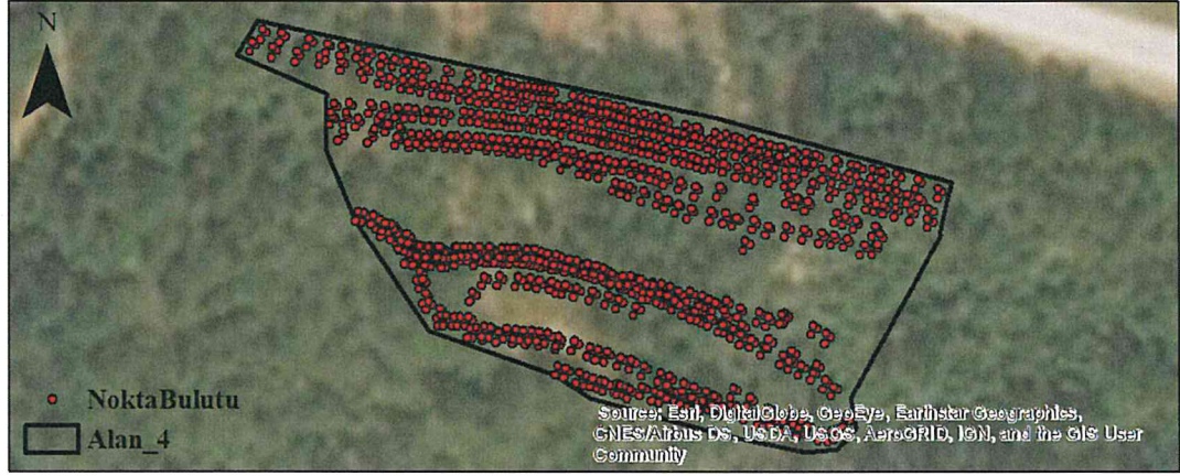
Şekil 3.24. 4 nolu Çalışma Alanına Ait Alan Sınırı ve Total Station Kullanılarak elde edilmiş Nokta Bulutu
