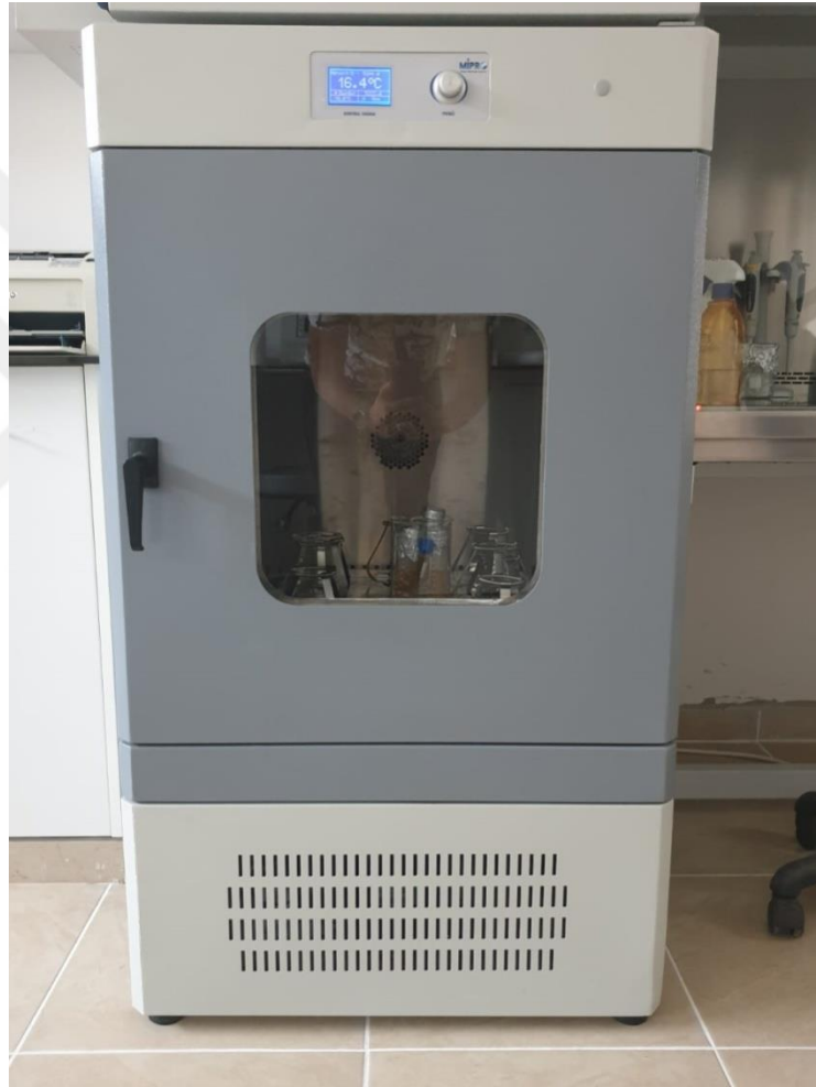
Fotoğraf 3.4. R. salmoninarum kültüründe kullanılan soğutmalı çalkalamalı inkübatör
