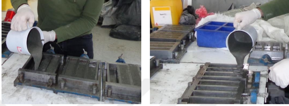
Şekil 3.10. UYPB döküm süreci
