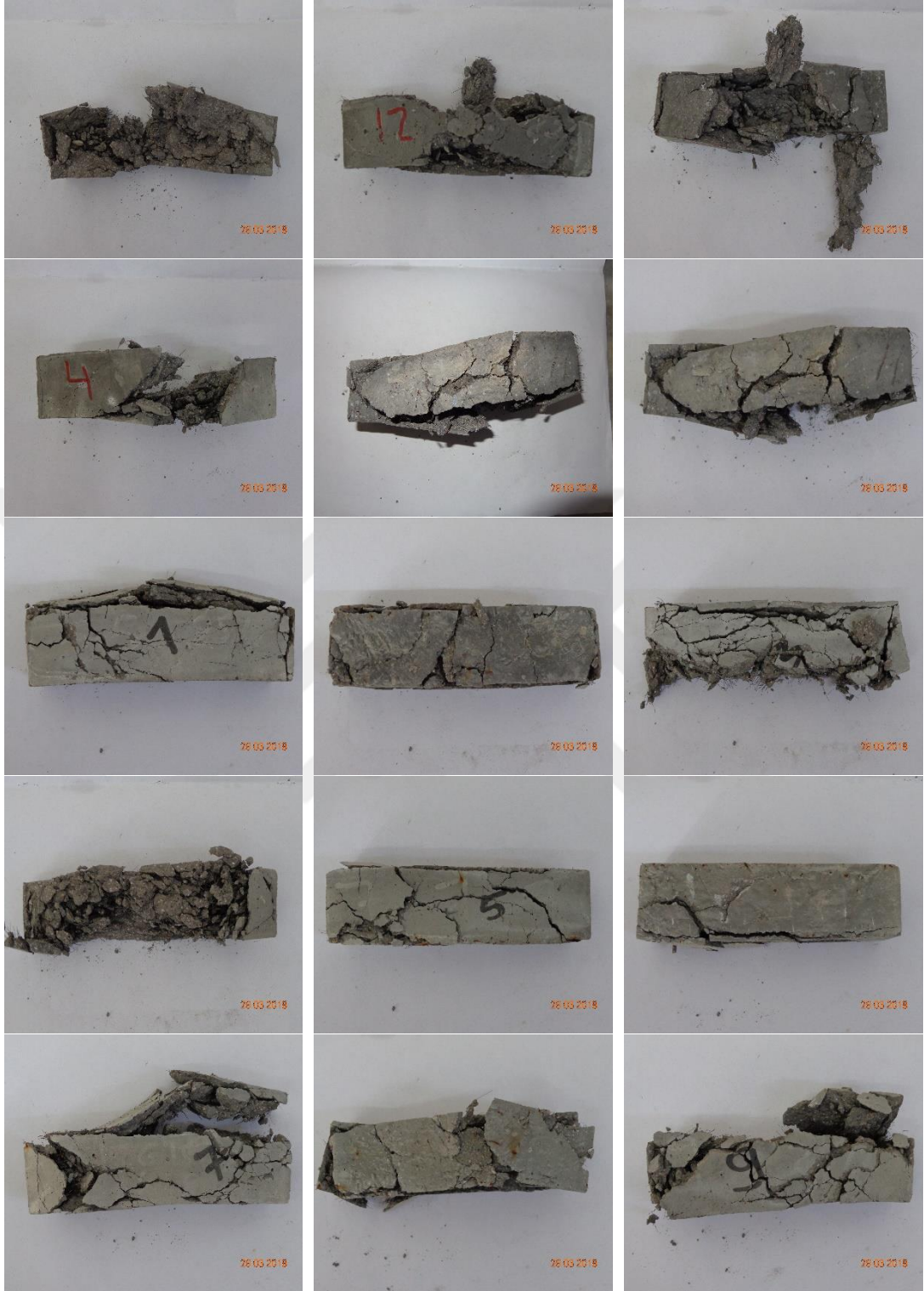
Şekil 4.25. 450 °C ve üzeri sıcaklıklardaki numune hasarları
