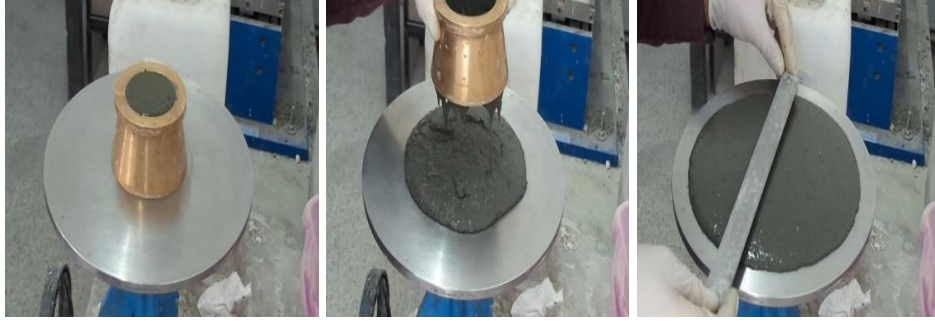
Şekil 3.12. Yayılma tablası test süreci ve çap ölçümü
