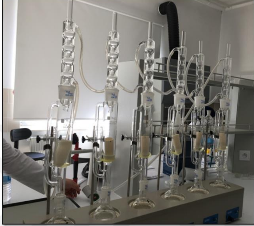
Fotoğraf 3.7. Soxhelet ekstraksiyon cihazı
