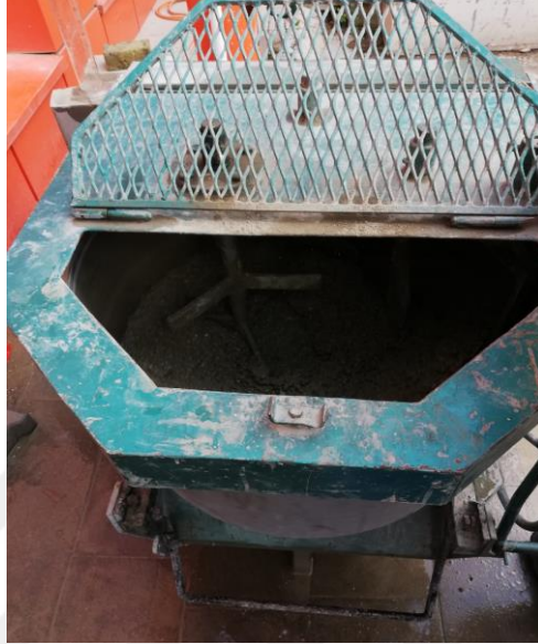
Şekil 3.9. Hafif beton malzemelerinin karıştırılması
