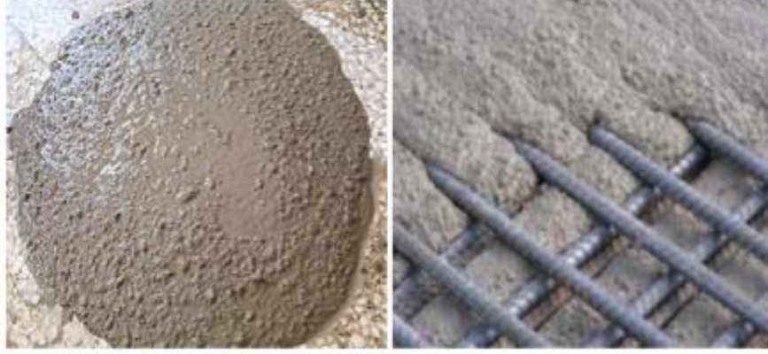
Şekil 2.5. Kendiliğinden yerleşen beton (Bostancı, 2014)
