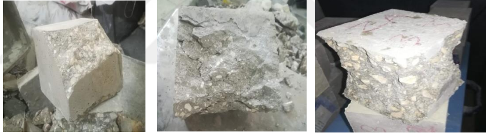
Şekil 3.19. Yüksek sıcaklık sonrası bazı KYB örnekleri
