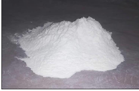
Şekil 3.6. Beton karışımında kullanılan MP
