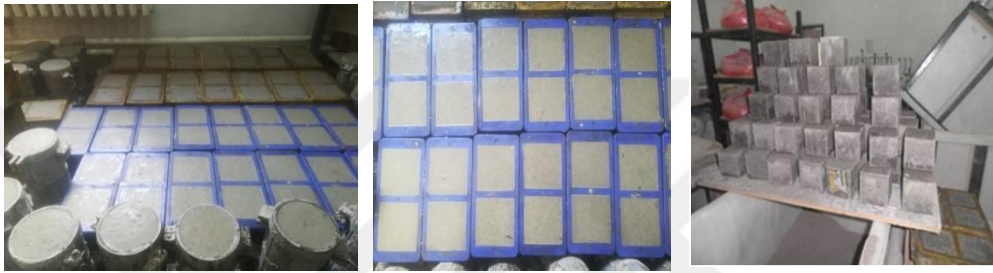
Şekil 3.9. Beton döküm süreci
