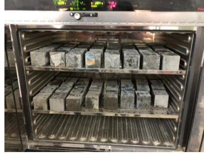
Şekil 3.15. Daldırma esnasında beton örnekler
