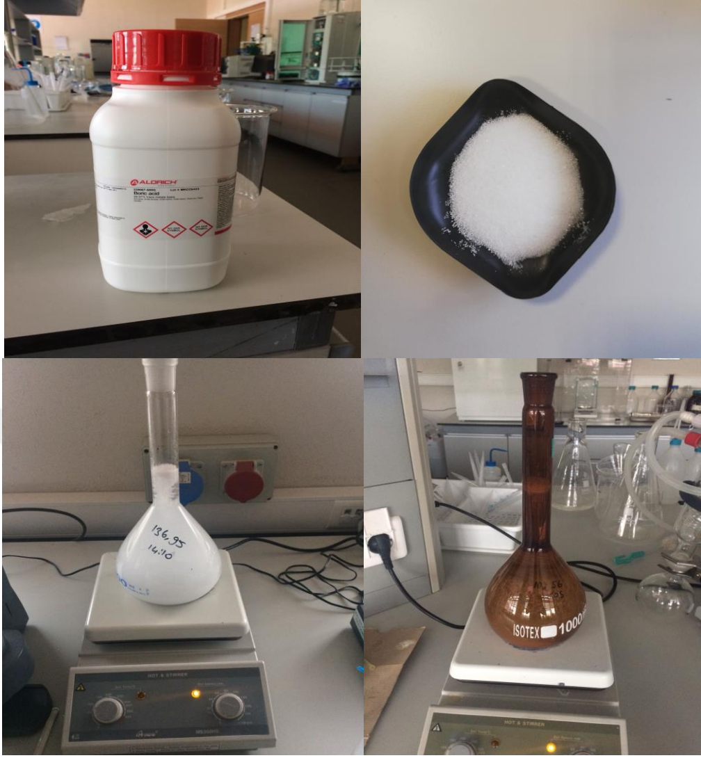
Şekil 3.2. Borik Asit Çözeltisi Hazırlanması
