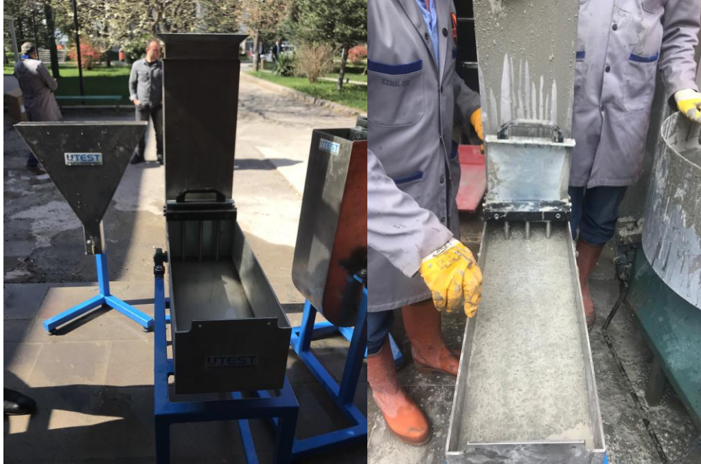
Şekil 3.11. L-Kutusu Deneyi Yapılışı
