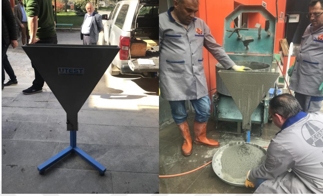
Şekil 3.7. V- Kutusu Deneyi Yapılışı
