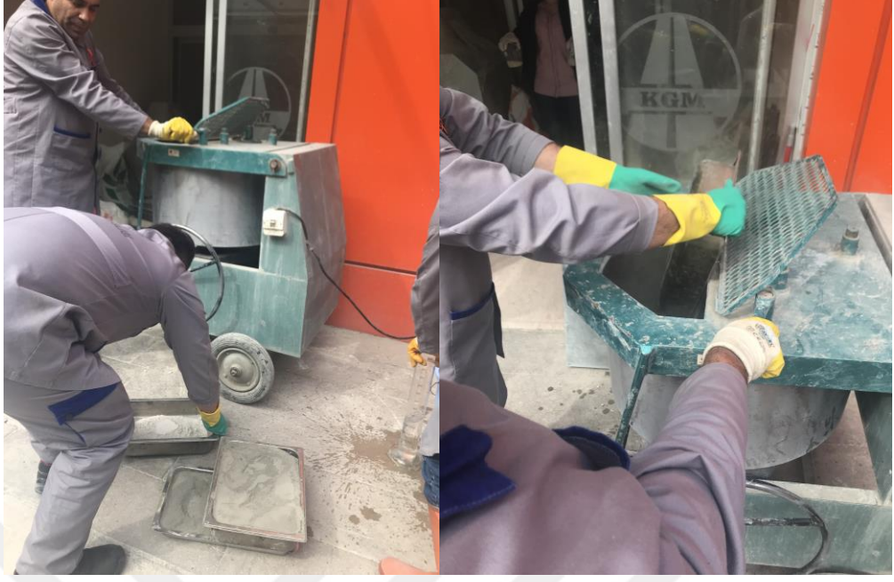
Şekil 3.1 KYB Üretimi Çimento Eklenmesi
