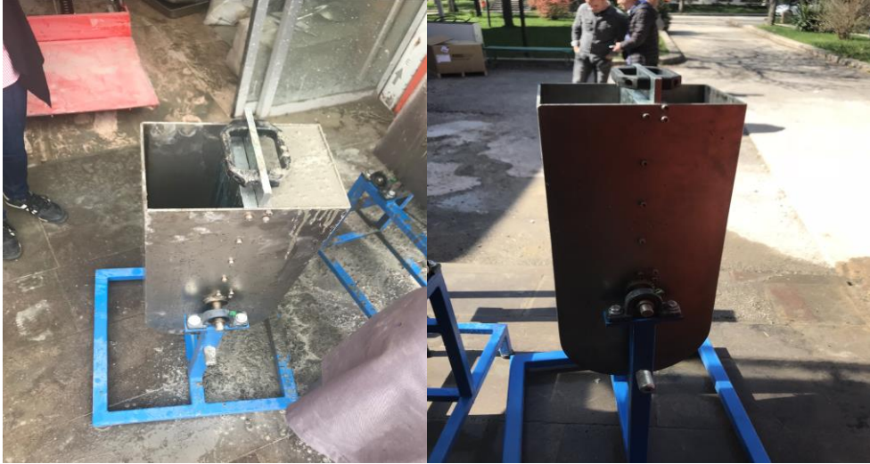
Şekil 3.9. U-Kutusu Deneyi Yapılışı
