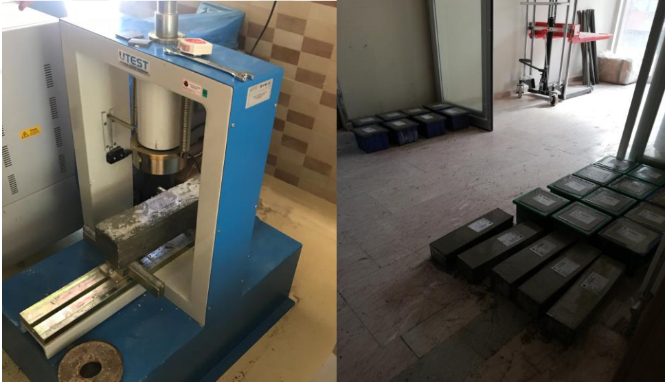
Şekil 3.15. Eğilme Deneyi Numuneleri ve Eğilme Testi
