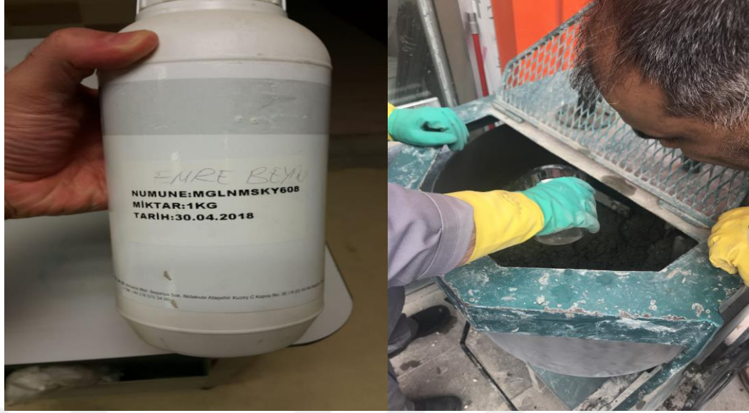
Şekil 3.4. KYB Üretimi Süperakışkanlaştırıcı Katkı Eklenmesi
