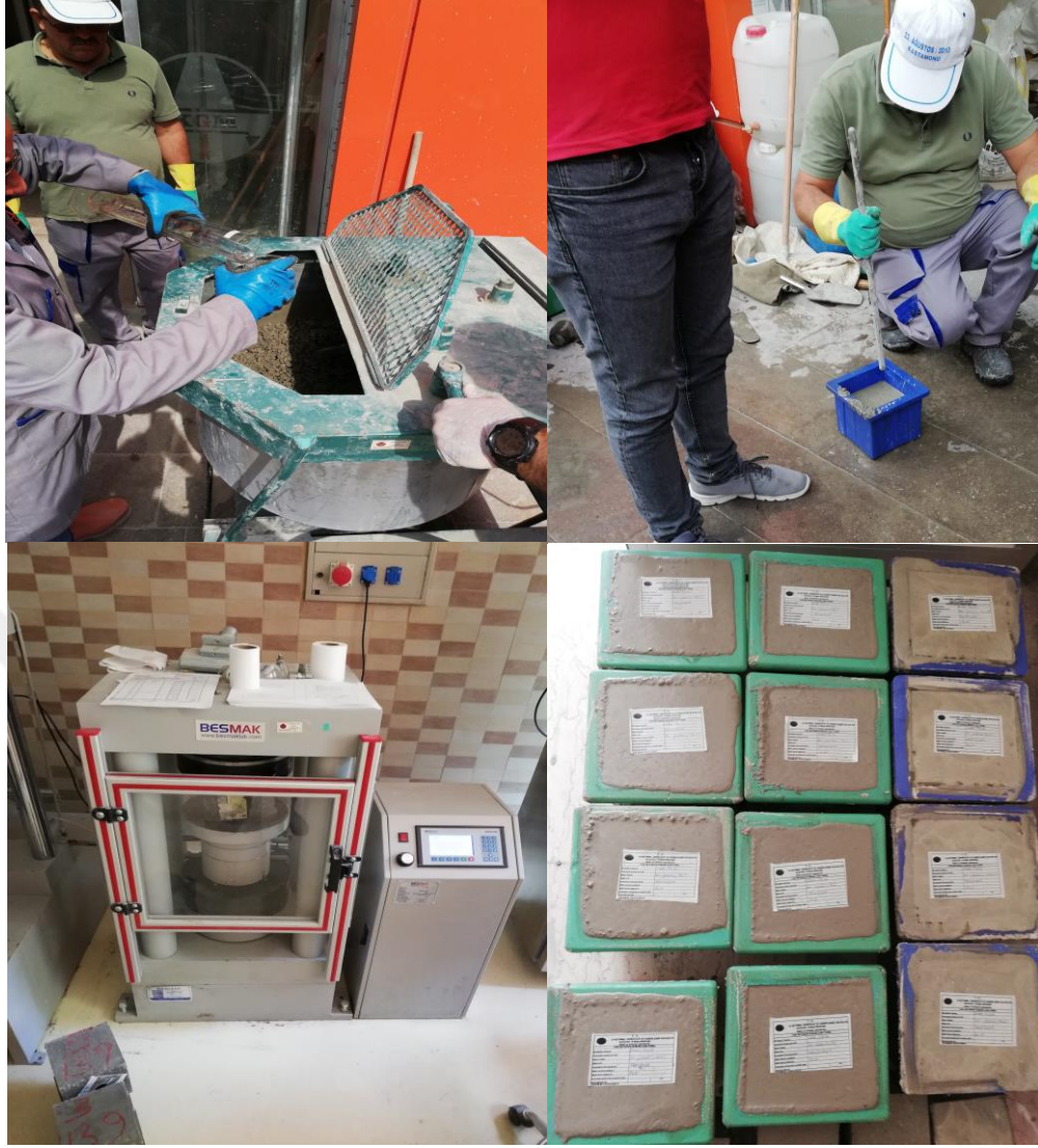
Şekil 3.13. Betonun Karışımı, Numune Alınması ve Basınç Dayanım Testi
