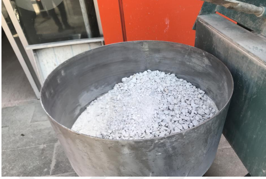
Şekil 3.3. KYB Üretimi Agrega Eklenmesi
