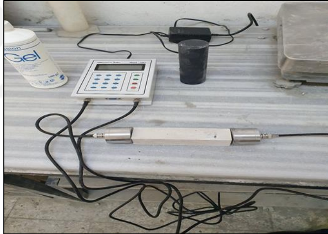
Şekil 3.14. Ultrases geçiş sürelerinin belirlenmesi
