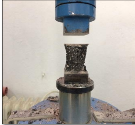
Şekil 3.12. Geopolimer beton basınç dayanım testi
