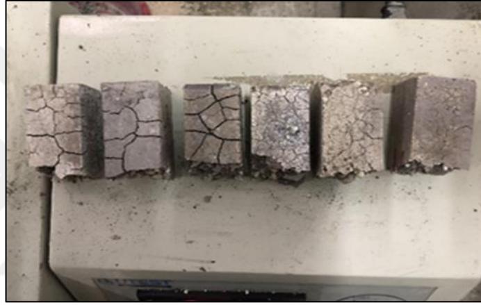
Şekil 3.15. Yüksek sıcaklık (900 °C) testi örnekleri
