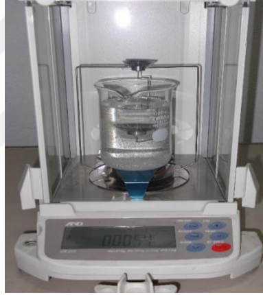
Fotoğraf 7.8. Yoğunluk ölçümünde kullanılan yoğunluk kitli hassas terazi
