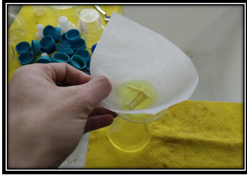
Fotoğraf 4.5. Filtreli kâğıt üzerinde temizlenen örnekler
