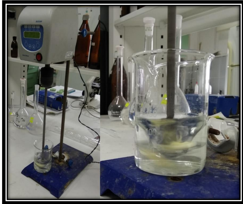
Fotoğraf 4.6. Liflerin laboratuvar mikserinde karıştırılması
