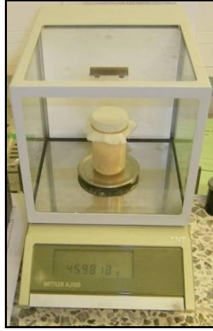
Şekil 5. 15. Deney için hazırlanan numunenin ağırlığının hassas terazide ölçülmesi.
